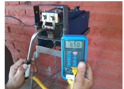
Пирометр показывает соответствующую температуру - 650°C.
