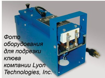
Процедура подрезки клюва инфракрасным лучом может быть адаптирована к местными условиям.
